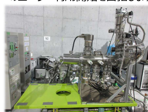
NanoTerasu実験ホールで 調整作業中のAP-HAXPES装置
